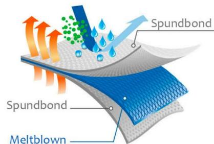
**1ª y 3ª CAPA:** Tela no tejida SS (Dos capas de SPUNDBOND) 20g: Es un manto de tela formado por filamentos continuos no orientados, los cuales son sometidos a un proceso de estiramiento y enfriamiento que le proporciona características de resistencia y elongación al producto terminado.
